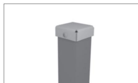
Закрепите крышку при помощи заклепок. Вторую крышку установить по аналогии с первой.
