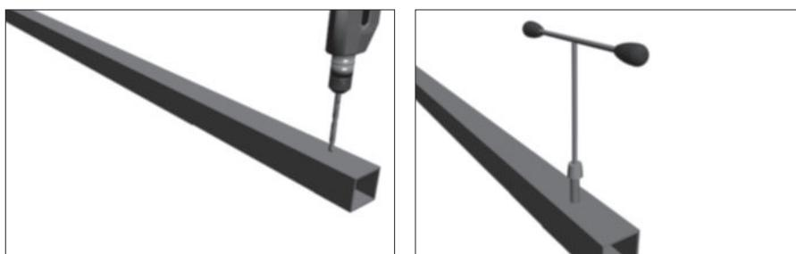
Сделайте отметки под крепление петель и просверлите отверстия Ø8 мм. Нарежьте резьбу под винты крепления петли метчиком M8x1,25.
