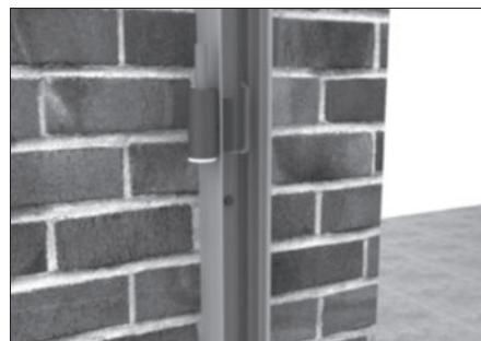
Закрепите профиль «корпус столба» к кирпичному столбу при помощи саморезов.
