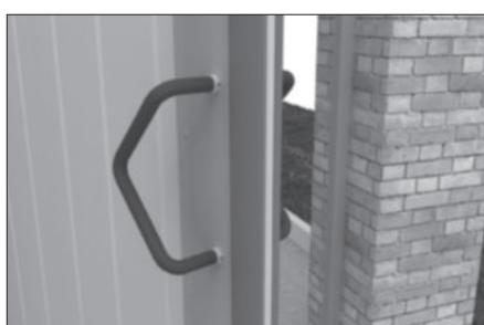
С помощью воротка попеременно закрутите оба винта по 3–5 мм за прием. Так как винты и ручки имеют правую и левую резьбу, то при вкручивании винта в первую ручку происходит одновременное вкручивание другого конца винта во вторую ручку.
