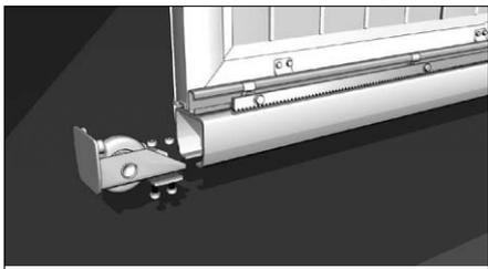
Ослабьте винты на корпусе поддерживающего ролика (10) и задвиньте ролик в переднюю часть балки до упора. Затяните винты, тем самым закрепив поддерживающий ролик с помощью прижимной пластины на балке щита с верхом столба.
