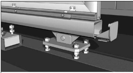
Аналогичным образом с другой стороны балки установите заднюю крышку балки (7).
