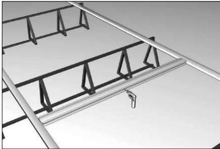
Просверлите отверстия  $\text{Ø}4,2$  мм для крепления профилей для сборки панелей (5) к промежуточной стойке (основной несущий профиль (2)). Расстояния между отверстиями должно составлять 100 мм.
