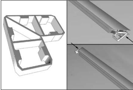
Установите угловые соединения щита (9) в боковой основной несущий профиль (2).
