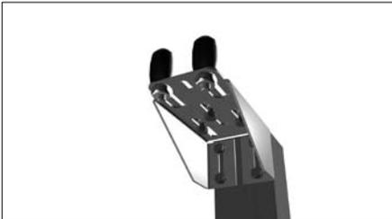
При установке полотна ворот отрегулируйте положение кронштейнов по высоте и затяните саморезы в технологических отверстиях, установите еще 2 самореза в технологические отверстия кронштейна и зафиксируйте местоположение кронштейна.
