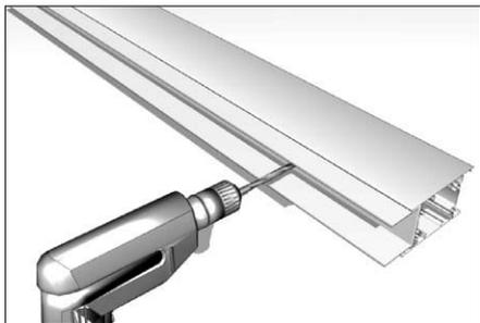
Просверлите отверстия сверлом Ø4,2 мм для крепления профиля для сборки панелей. Расстояние между отверстиями - 100 мм.
