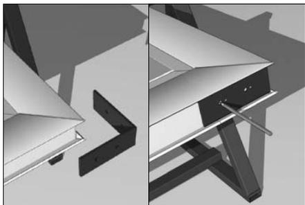
Установите шаблон (13) на углы полотна ворот и наметьте отверстия для крепления.
