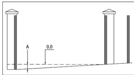
Нулевым уровнем является плоскость окончателного дорожного покрытия в зоне проема. Если уровень дорожного покрытия не горизонтален, то нулевым считается уровень, показанный на рисунке, и при расчетах необходимо учитывать размер А для определения высоты столбов. Для установки нулевого уровня используется капроновая нитка и строительные уровни.
