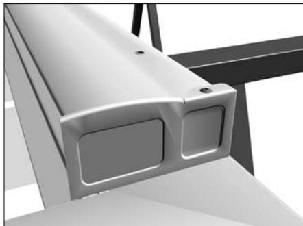
Установите боковые крышки на профиль карниз ролика направляющего. Закрепите крышки при помощи заклепок.
