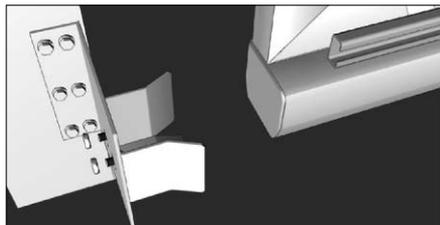
С помощью болтов, входящих в комплект ловителя, закрепите нижний ловитель (5) на кронштейне и отрегулируйте его положение при помощи вертикальных регулировочных пазов так, чтобы передний поддерживающий ролик полотна ворот касался лотка ловителя.
