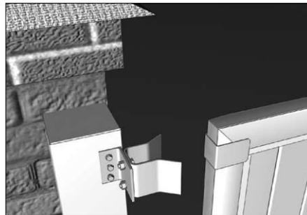
Установите металлическую накладку на полотно на одном уровне с верхним ловителем и закрепите её с помощью заклёпок.
