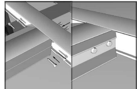
Скрепите основные несущие профили (2) через сухарное соединение (10) с помощью саморезов по металлу (11).
