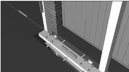
Перед началом заливки котлована бетоном установите раму (1) в котлован и закрепите её в распор с помощью отрезков арматуры, при этом, верхняя плоскость швеллера должна находиться на нулевом уровне, а первый опорный столб установите заподлицо со столбом, ограничивающим проем.
