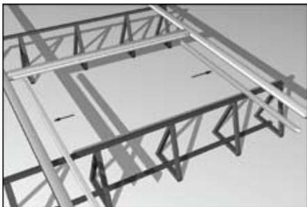
Отрежьте два профиля для сборки панелей (5). Предварительно спилите их концы под углом 45°.
