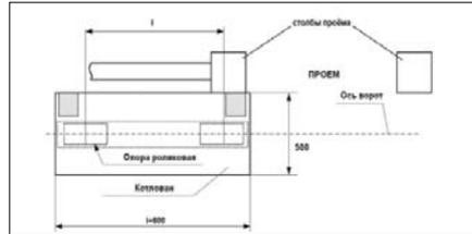
Выкопайте котлован глубиной 1500 мм, шириной 500 мм, и длиной, указанной в монтажной карте (i+600), в соответствии с разметкой. Проведите песчано-гравийную подсыпку для котлована на высоту 100 мм. Бетонная подушка должна начинаться от края проема, а ее боковой край должен примыкать к поверхности столбов заказчика, если в карте бетонирования нет других указаний.
