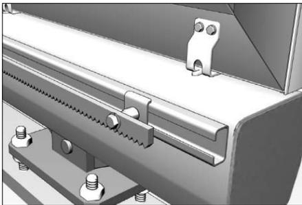
В случае, если установлена балка (1) размером 138x143x6 мм, «с»-профиль (20) крепится непосредственно к балке с помощью саморезов по металлу (11). Расстояние между точками крепления не более 500 мм. Под саморезы (11) необходимо подложить по две шайбы (21).
