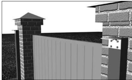
Разберите кронштейны (8) на 2 составные части. Приложите первый кронштейн к столбу силовой рамы, располагающемуся рядом с проемом, таким образом, чтобы его торцевой край прилегал заподлицо со столбом рамы, а верхняя плоскость кронштейна была выровнена с верхом столба. Просверлите 4 отверстия 4мм и закрепите кронштейн саморезами.
