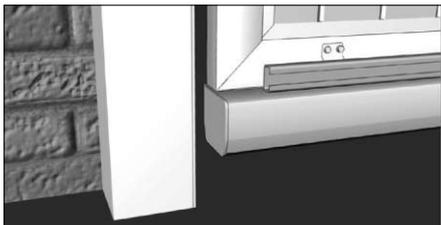
Полотно ворот (1) установите в положение "ЗАКРЫТО". Отметьте место касания нижнего края балки и столба ловителя.
