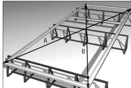
Установите второй боковой несущий профиль (2) и измерьте диагонали каркаса ворот (они должны быть равны,  $A=B$ ). Прикрепите профили к каркасу с помощью заклёпок.
