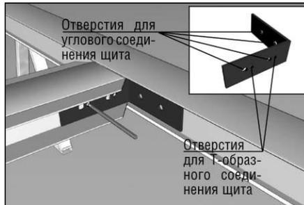
Через кондуктор (13) разметьте отверстия в промежуточном профиле для крепления его к T-образному соединению щита (10).
