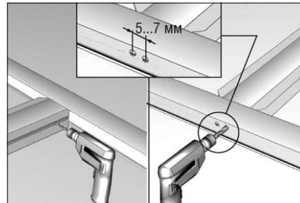
Просверлите отверстия сверлом  $\text{Ø}4,2$  мм в промежуточном профиле (2) и  $\text{Ø}15$  мм в верхнем и нижнем несущих профилях (2).
