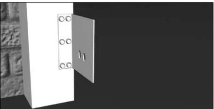
На уровне отметки закрепите кронштейн крепления нижнего ловителя (5) с помощью 6 саморезов по металлу так, чтобы его нижний край находился на одном уровне с нижним краем балки ворот.
