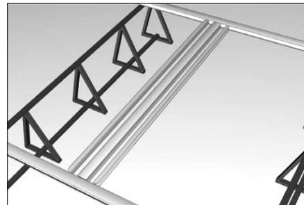
Отпилите два профиля для сборки панелей (5) и установите на промежуточный несущий профиль (2). Предварительно, концы профилей отпилите под углом 45°.
