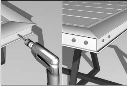
Просверлите отверстия сверлом  $\text{Ø}4.2$  мм и скрепите профили с помощью саморезов (11).
