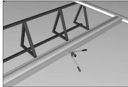
Затем закрепите их с помощью заклёпок (11) и клепателя.
