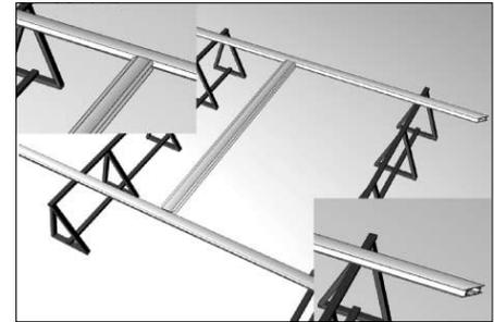
Выставьте промежуточный несущий профиль (2) согласно расчётным размерам, указанным в монтажной карте.
