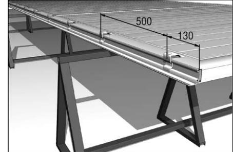
Разместите на нижней части щита оцинкованные кронштейны крепления щита к балке (8). Расстояние от края балки до кронштейна должно составлять 130 мм, а между кронштейнами 500 мм.
