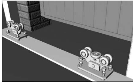
Открутите по одной верхней гайке с гроверной шайбой с каждого из четырех винтов на верхней площадке силовой рамы (2). Оставшиеся на винтах гайки установите на одинаковую высоту от плоскости верхней площадки (величина просвета, указанная в карте монтажника). На эти гайки сверху установите роликовые опоры (4). Наденьте на винты снятые ранее гроверные шайбы и гайки.
