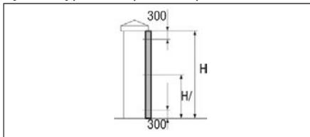
Монтажный столб закрепите к столбу проема при помощи 3-х анкерных болтов №13, располагающихся по высоте, как указано на схеме.
