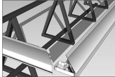
Соедините боковой основной несущий профиль (2) с верхним и нижним несущими профилями (2). Проверьте точность стыковки углов профилей и отсутствие зазоров между соединениями.
