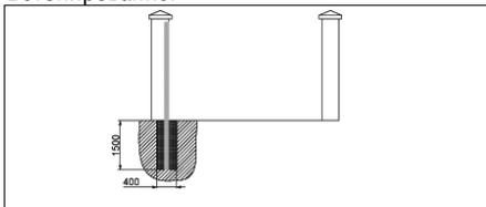
бами силовой рамы, вровень со столбом проема. Выставьте столб по строительному уровню, закрепите за края котлована, используя отрезки арматуры. Бетонная подушка должна выступать за края проема, а ее боковой край должен примыкать к поверхности столба забора, если в карте бетонирования нет других указаний. Верхняя поверхность бетонной подушки должна быть выведена на расчетный нулевой уровень проема ворот.
