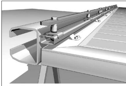
Если установлена балка размером 95x88x5 мм: возьмите «С»-профиль (20), предназначенный для установки зубчатой рейки электропривода (15) и установите его на кронштейны (8) по всей длине полотна ворот и закрепите при помощи саморезов (11), предварительно просверлив отверстия сверлом Ø4,2 мм.
