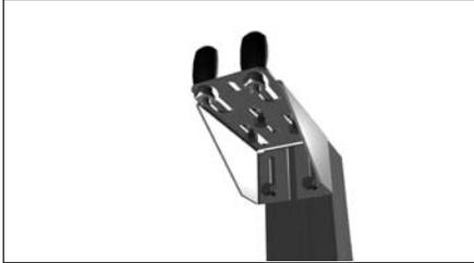
Приложите первый кронштейн (9) к столбу силовой рамы, располагающемуся рядом с проемом, таким образом, чтобы его торцевой край прилегал заподлицо со столбом рамы, а верхняя плоскость кронштейна была выровнена с верхом столба. Просверлите 2 отверстия 4мм в нижней части пазов кронштейна и закрепите кронштейн саморезами 6,3x25, но не затягивайте их.
