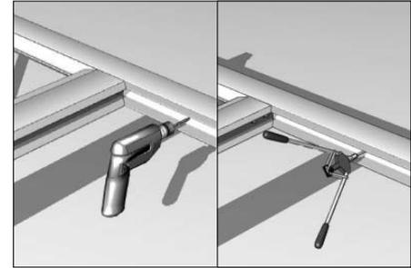
Закрепите профили для сборки панелей к верхнему и нижнему несущим профилям (2) с помощью заклёпок (12).
