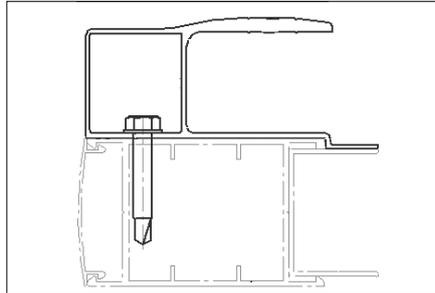
Закрепите профиль карниз ролика направляющего саморезами 5,5x32 мм. со сверлом к основному несущему профилю.
