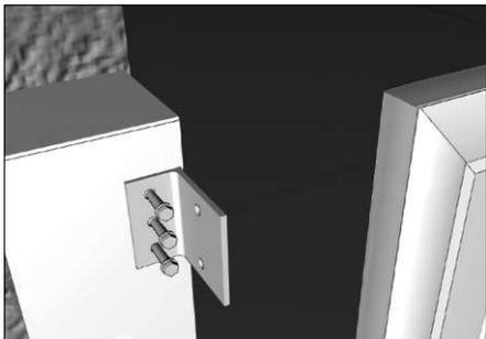
Аналогичным образом закрепите кронштейн верхнего ловителя (6) с помощью саморезов по металлу.
