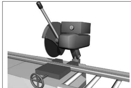
Пила циркулярная поворотная для резки алюминиевых профилей.
