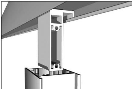
Состыкуйте его с верхним и нижним несущими профилями при помощи «Т»-образного соединения щита ворот DoorHan (9).
