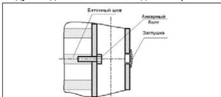
Анкерные болты располагайте только в бетонных швах. Просверлите отверстия под крепеж в монтируемых столбах: под анкерные болты – Ø13 мм, под заглушки – Ø22 мм.
