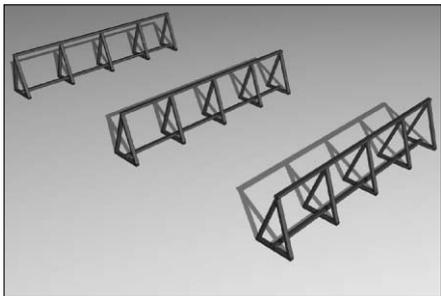
Стапели для сборки полотна ворот. Верхние балки покрыть мягким материалом (ковролин, линолеумом и т.п.) Материал: Труба 60х30 мм.
