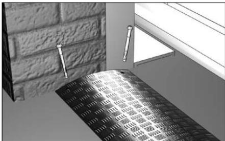
Установите лежачий полицейский вдоль проёма под полотном ворот и закрепите его по краям четырьмя анкерными болтами 12x120 (11).
