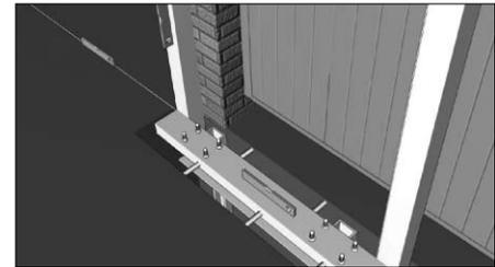
Натяните нитку на нулевом уровне. Противоположный конец нитки расположите в 100 мм от столба проема. Это необходимо для того, чтобы будущий столб-ловитель (3) находился в одной плоскости со столбами силовой рамы (2). Перед бетонированием выставьте раму (2) по строительному уровню. Марка бетона должна соответствовать бетону 200. В том случае, если бетонирование происходит в зимнее время, необходимо использовать бетон со специальными добавками.
