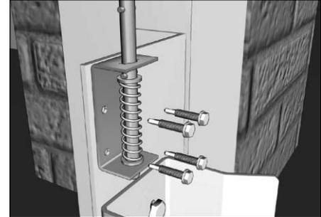
На кронштейн нижнего ловителя разметьте и просверлите отверстия сверлом Ø4 мм для крепления задвижки.
