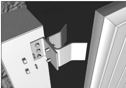
К кронштейну с помощью болтов с гайками закрепите верхний ловитель (6).
